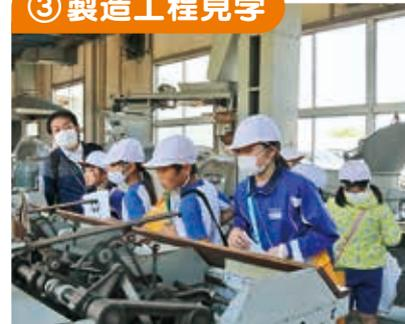
校内の製造工場で、茶葉を蒸したり、熱風で乾かす工程などを見学しました。お茶の葉を摘んでから飲めるまで、約7時間かかります。
