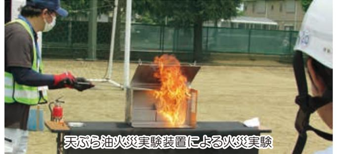
天ぷら油火災実験装置による火災実験
